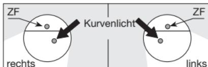
Das Zusatzfernlicht (ZF) wird gemeinsam mit dem Fernlicht des Hauptscheinwerfers eingeschaltet. Das Kurvenfernlicht wird bei Kurvenfahrten durch die Steuerelektronik automatisch eingeschaltet und nach Beendigung der Kurven-
