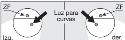
La luz adicional de carretera (ZF) se conecta conjuntamente con la luz de carretera de los faros principales. La luz para curvas es conectada automáticamente por la electrónica de mando, para quedar atenuada tras recuperar la dirección.
