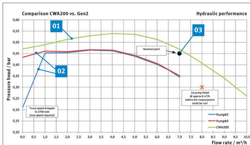
Mesures hydrauliques comparatives dans le laboratoire de test de Pierburg (document original)
