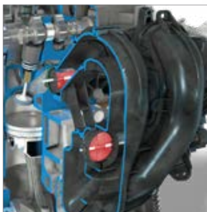
Válvulas en la tubería de aspiración
