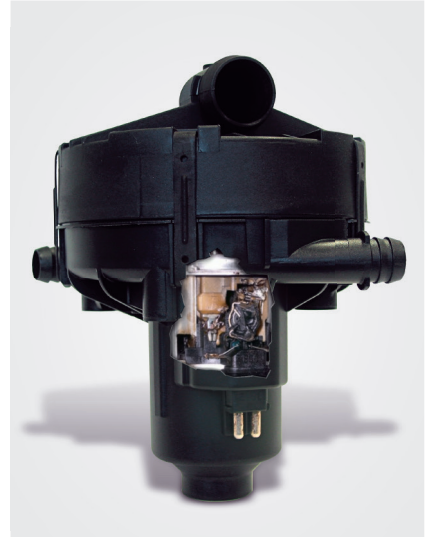
Erime izlerinin olduğu sekonder hava pompasına yakından bakış (kesit)
