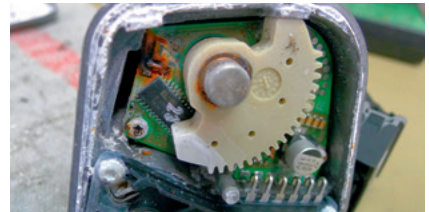
Hasarlı bir ayar klapesinin içten görünümü
