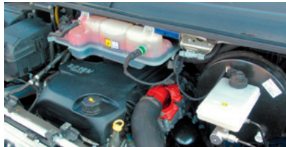
Iveco Daily 3.0 l motor bölmesindeki ayar klapesi (kırmızı vurgulanmıştır)
