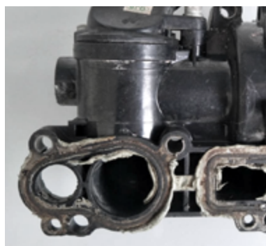
Fig. 5: Fugas debido a un agente obturador adicional (manifestación de la avería)
