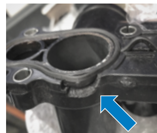
Fig. 3 : Cassure (vue du dommage)
