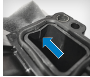
Şek. 2: Kırılma (hasar belirtisi)
