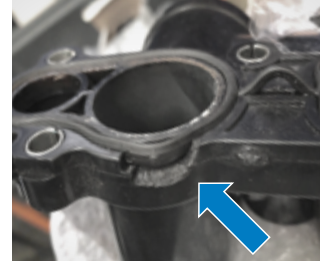
Şek. 3: Kırılma (hasar belirtisi)
