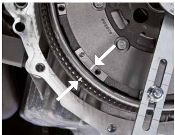
7. Sekundärschwungscheibe mit dem Hebel im Uhrzeigersinn drehen, bis die Federkraft der Bogenfedern spürbar ist. Hebel langsam loslassen, bis die Bogenfedern entspannt sind
