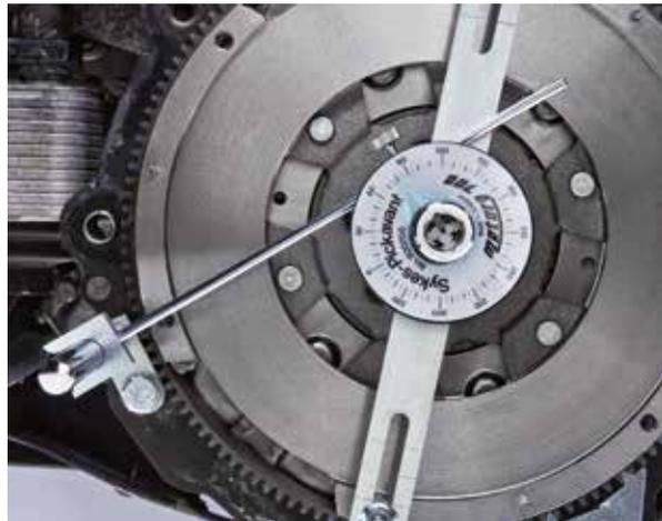
7. Sekundärschwungscheibe mit Hebel gegen den Uhrzeigersinn drehen, bis die Federkraft der Bogenfedern spürbar ist
