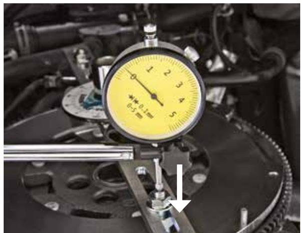
4. Hebel leicht (beispielsweise mit einem Finger) in die entgegengesetzte Richtung ziehen, bis ein Widerstand zu spüren ist. Wert auf Messuhr ablesen und mit dem Sollwert vergleichen (siehe Kapitel 8)
