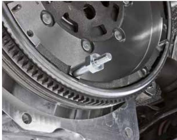
3. Hebel an die Adapter anbauen – Langlöcher mit Hilfe der Einteilungen mittig zu den Adaptern ausrichten und Muttern festziehen
