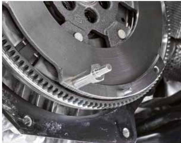
3. Hebel an die Adapter anbauen – Langlöcher mit Hilfe der Einteilungen mittig zu den Adaptern ausrichten und die Muttern festziehen
