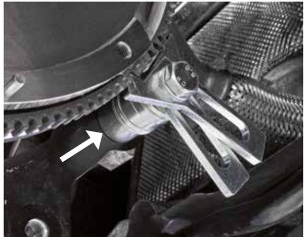
5. Messuhrhalter am Motorblock montieren – Getriebeschraube und ggf. Buchse analog zum Blockierwerkzeug verwenden
