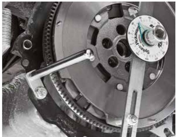
Eventuell können das Blockierwerkzeug und der Messuhrhalter zusammen an einer Schraube montiert werden.
