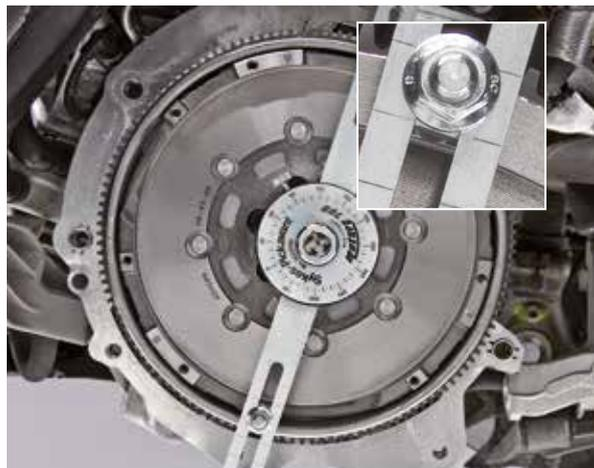
4. ZMS blockieren – Getriebeschraube und ggf. Distanzstücke verwenden, um das Blockierwerkzeug auf der Höhe des Anlasserzahnkranzes zu befestigen
