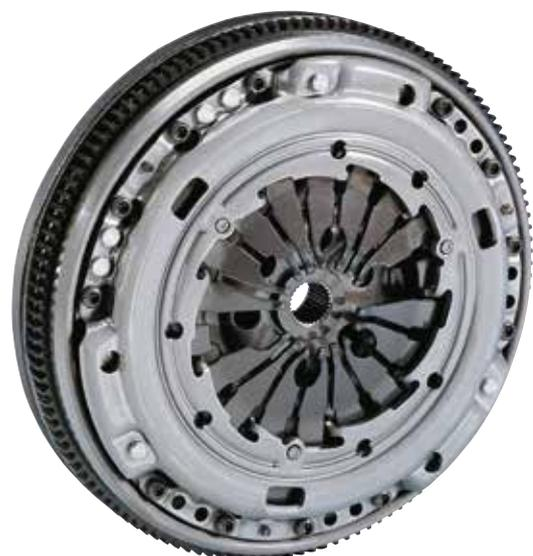
Die ZMS der ersten Generation enthielten Federkonfigurationen wie bei konventionellen Torsionsdämpfern, bei denen die Druckfedern radial weit innen angeordnet waren und deshalb nur ein geringes Federvolumen zur Verfügung stand. Die Schwingungsisolierung von 6-Zylinder-Motoren war damit gewährleistet, da diese eine niedrigere Resonanzdrehzahl haben.
