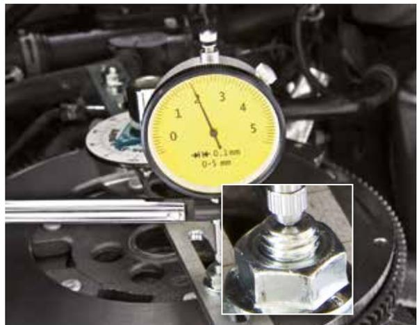
3. Hebel leicht (z. B. mit dem Daumen) in Richtung Motor drücken, bis ein Widerstand zu spüren ist
