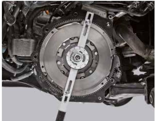
In wenigen Fällen liegt eine ungerade Anzahl an Befestigungsgewinden für die Kupplungsdruckplatte vor, und man kann den Hebel nicht mittig montieren. In diesen Ausnahmefällen muss der Freiwinkel über die Zählung der Zähne des Anlasserzahnkranzes ermittelt werden (siehe Kapitel 7.3).
