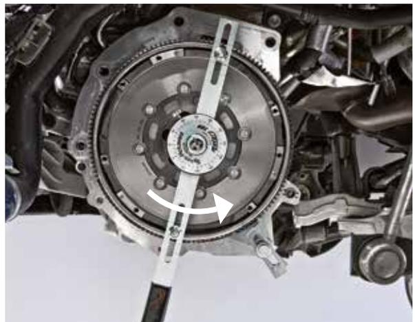
6. Hebel langsam loslassen, bis die Bogenfedern entspannt sind
