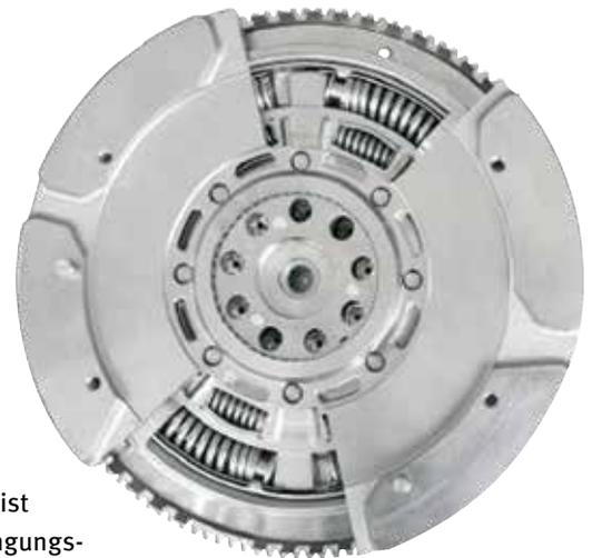
Die Gleitschalen gewährleisten eine gute Führung, und eine Fettfüllung im Federkanal verringert die Reibung zwischen Bogenfeder und Gleitschale.
