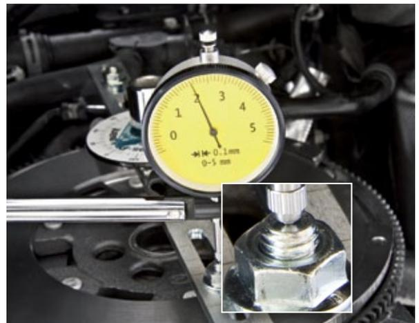
3. Pousser légèrement le levier (par ex. avec le pouce) vers le moteur jusqu'à ce qu'une résistance se fasse sentir.
