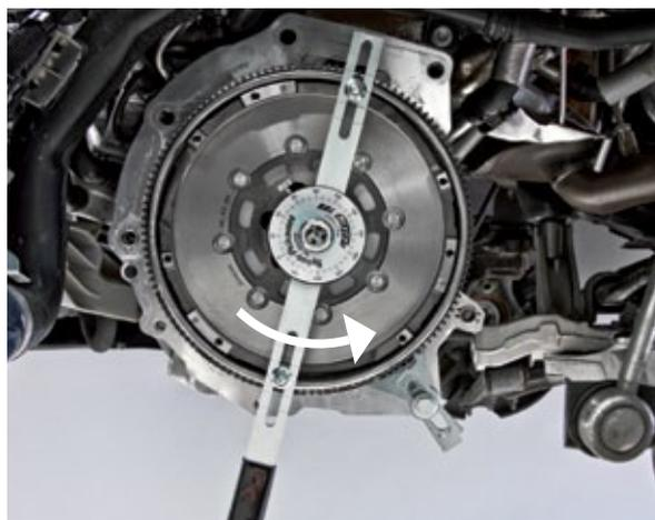
6. Lâchez doucement le levier jusqu'à ce que les ressorts en arc soient détendus.
