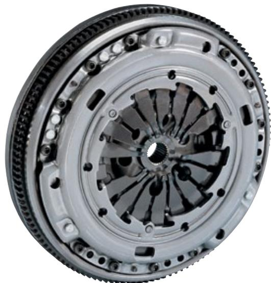
Les volants bimasse de la 1ère génération comportaient des ressorts agencés comme ceux des amortisseurs de torsion traditionnels: la disposition radiale des ressorts de compression, placés très près du centre, ne permettait qu'un faible volume de ressort. L'isolation des vibrations n'était ainsi bien maîtrisée que dans les moteurs 6 cylindres du fait de leur faible régime de résonance.
