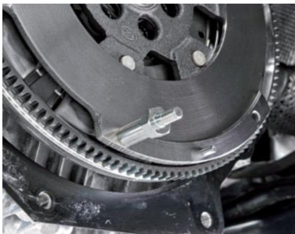
3. Monter le levier sur les adaptateurs – centrer les fentes par rapport aux adaptateurs puis serrer les boulons.
