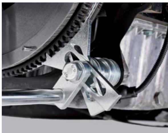
6. Fixer le disque gradué avec la pièce de blocage sur le support du comparateur à cadran et serrer les boulons moletés.
