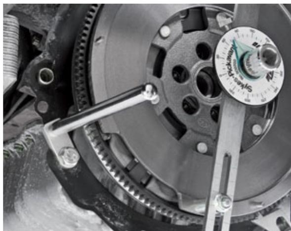
Dans certains cas il est possible de monter l'outil de blocage et le support du comparateur à cadran avec la même vis.
