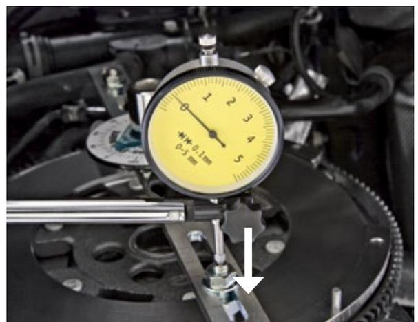
4. Tirer le levier légèrement (par. ex. avec un doigt) dans le sens inverse jusqu'à ce qu'une résistance se fasse sentir. Relever la valeur indiquée sur le comparateur à cadran et la comparer avec la valeur prescrite (voir chapitre 7).
