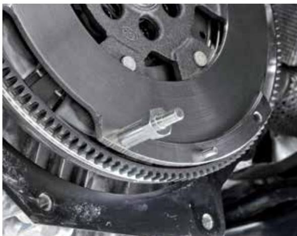
3. Montare la leva sull'adattatore – allineare le asole al centro dell'adattatore aiutandosi con le scale graduate e stringere i dadi. Il disco graduato deve trovarsi al centro del volano a doppia massa.
