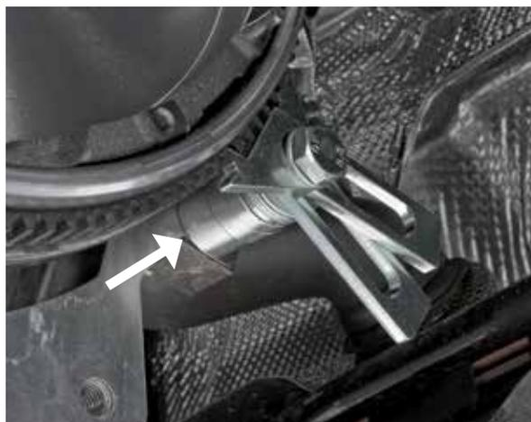
5. Ruotare con la leva il disco secondario del volano in senso antiorario fino a rilevare la resistenza elastica delle molle ad arco.
