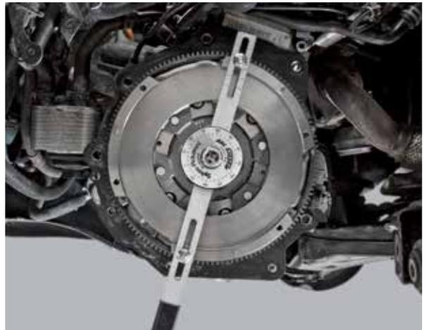
In rari casi è presente un numero dispari di filettature di fissaggio per lo spingidisco della frizione e non è possibile montare la leva al centro. In questi casi eccezionali l'angolo di incidenza deve essere determinato contando i denti della corona di avviamento – vedere capitolo 6.3.
