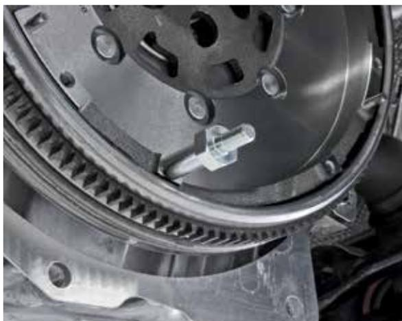
3. Montare la leva sull'adattatore – allineare le asole al centro dell'adattatore aiutandosi con le scale graduate e stringere i dadi. Poiché le filettature di fissaggio per lo spingidisco della frizione sono in numero dispari, la leva non può essere montata al centro del volano a doppia massa.
