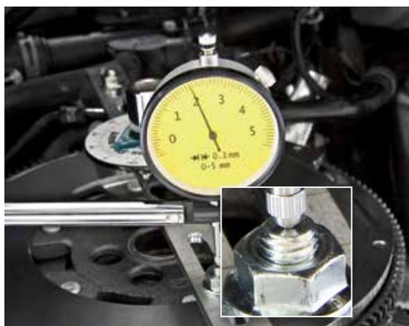
3. Premere leggermente la leva (ad esempio con i pollici) in direzione del motore fino a sentire una resistenza. Mantenere la leva in questa posizione e regolare il comparatore su "0".
