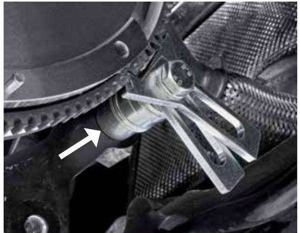
5. Montare il supporto del comparatore sul monoblocco del motore – utilizzare una vite adatta (ad esempio quella che fissa il cambio al monoblocco stesso) e se necessario la boccola come fatto per l'utensile di bloccaggio.
