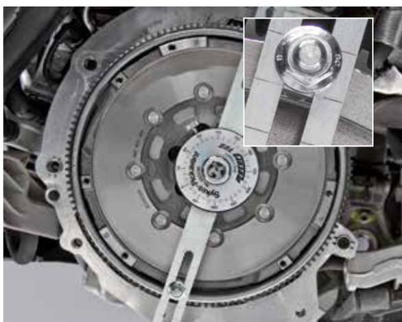
4. Bloccare il DMF – utilizzare una vite della frizione e distanziali, se necessario per fissare l'utensile di bloccaggio all'altezza della corona dentata di avviamento.
