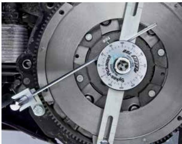
7. Ruotare con la leva il disco secondario del volano in senso antiorario fino a rilevare la resistenza elastica delle molle.
