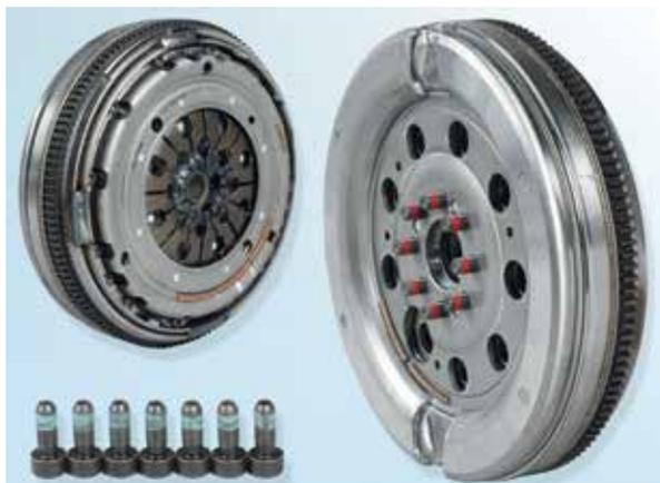
La sostituzione del volano a doppia massa o di quello compatto (DFC) prevede obbligatoriamente l'impiego di nuove viti di fissaggio specifiche sulle quali è depositato un particolare frena filetti.
