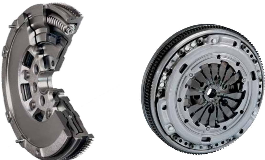
Nei volani a doppia massa di prima generazione, la configurazione delle molle era simile a quella dei convenzionali smorzatori torsionali, nei quali le molle di compressione erano disposte in senso radiale in prossimità del centro del disco frizione. Lo spazio per il loro alloggiamento era perciò ridotto e la dimensione degli smorzatori non poteva essere adeguatamente aumentata. La prima generazione del volano doppia massa assicurava comunque la riduzione delle vibrazioni
