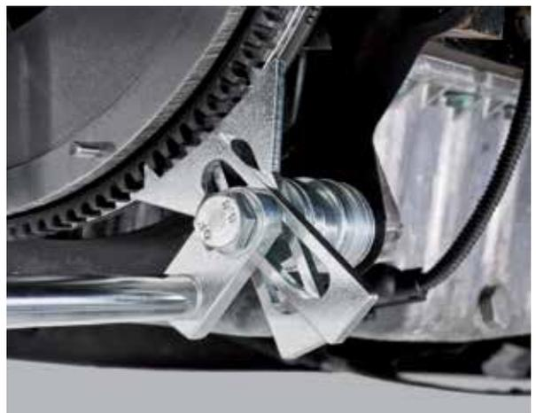
6. Fissare il disco graduato con la tiranteria al supporto del comparatore e serrare i dadi zigrinati.
