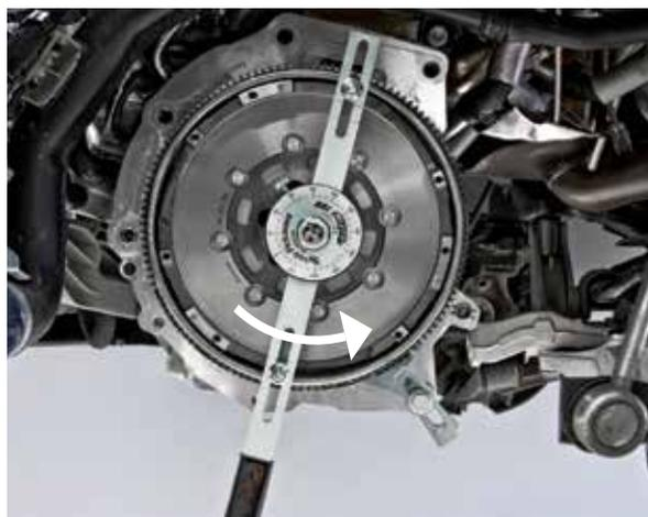
6. Rilasciare lentamente la leva fino a decomprimere le molle ad arco. Contrassegnare alla stessa altezza il disco secondario del volano e il disco primario del volano/ la corona di avviamento.
