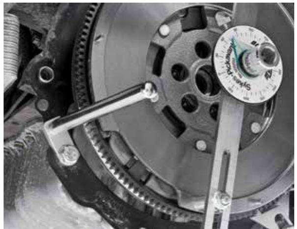
Se necessario, l'utensile di bloccaggio e il supporto del comparatore possono essere montati insieme con una sola vite.
