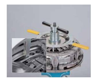
Accrocher les languettes du dispositif de la sécurité prévu pour le transport de l'embrayage K1 à l'aide des pièces de fixation
