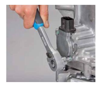
• Dévisser les vis de fixation des actuateurs de levier
