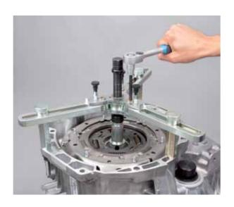
Serrer l'embrayage sur l'arbre creux en tournant la broche sur la douille de pression; arrêter le serrage dès que la rainure du circlip apparaît entièrement dans une des fenêtres de la douille de pression et que l'effort de rotation augmente sensiblement.
