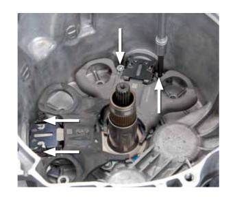
• Enlever le dispositif de sécurité prévu pour le transport des deux actuateurs de levier
