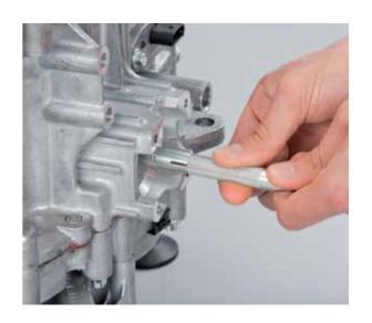
Appliquer une infime couche de graisse sur la broche des actuateurs de levier et les arbres des moteurs de pilotage d'actuateur
