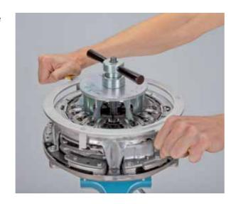
Poser la bague de pression Ø 85 mm (KL-0500-7111) sur le diaphragme K1
