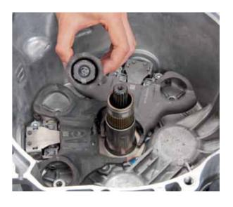
Les 4 chiffres du milieu se trouvant sur le ressort antagoniste doivent être identiques aux 4 derniers chiffres de l'actuateur de levier.
