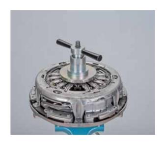
Introduire la petite bague de réinitialisation pour K1 (KL-0500-715) dans les 3 fentes de la rampe de compensation pour K1
