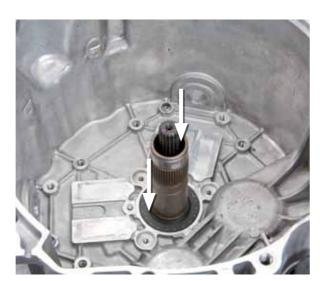
• Vérifier que les douilles et goupilles d'ajustage sont bien en place
