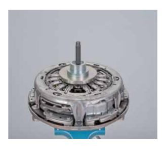
• Démonter l'écrou de serrage, la pièce de pression et la bague de réinitialisation
