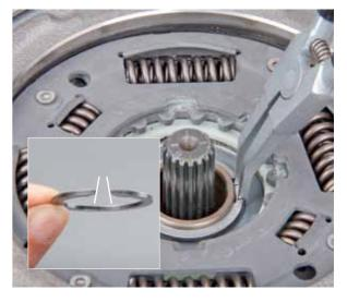
• Monter le moyeu du disque d'embrayage supérieur (K1), un trait indique le bon positionnement
