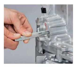
• Insérer la clé de déverrouillage dans l'actuateur de levier pour K1 avec le marquage vers le haut
