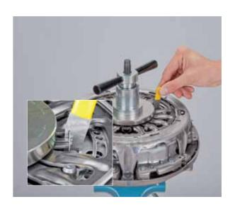
Tourner la bague de réinitialisation dans le sens des aiguilles d'une montre (direction de la flèche) jusqu'à la butée
