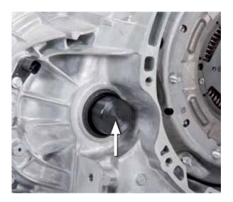
Fixer la boîte de vitesses sur le dispositif de montage approprié ou la poser sur un établi en la sécurisant avec le pied d'appui (KL-0500.802) de sorte que la cloche d'embrayage soit stable et positionnée à l'horizontale.
