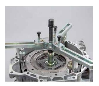
• Serrer les vis moletées dans les crochets à la main
