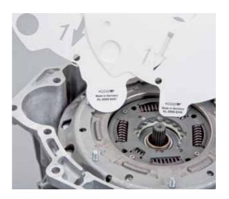
Positionner le pochoir de sorte que les alésages de l'embrayage (flèche) apparaissent au niveau des 3 grandes ouvertures.
