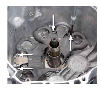
• Retirer les moteurs de pilotage d'actuateur
