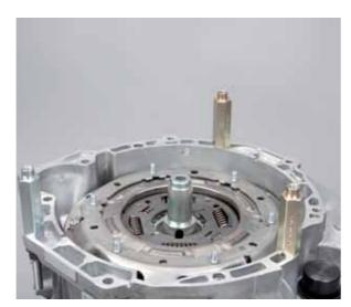
Monter le support de broche à 3 branches (KL-0500-60) avec les vis moletées (KL-0500-6020) sur les boulons filetés sans forcer
