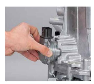
• Serrer les nouvelles vis sur le socle des actuateurs avec un couple de 19 Nm.
