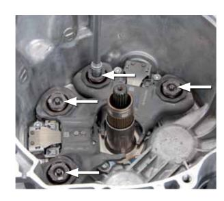
• Démonter les trois vis de la douille de guidage
