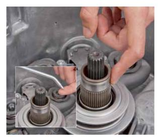
Monter les poignées et poser l'embrayage sur l'arbre creux. Une légère rotation permet une bonne prise des dentures du disque d'embrayage K2 et de l'arbre creux.
