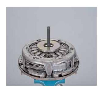
Maintenir d'une main la bague de réinitialisation dans cette position et de l'autre serrer l'écrou de pression jusqu'à la butée
