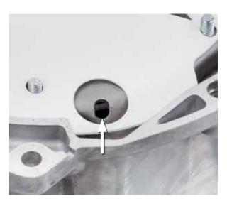
Tourner l'embrayage jusqu'à ce que le pochoir soit positionné dans la cloche de la boîte de vitesses comme le montre la photo.
