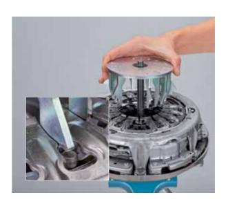
• Serrer les vis moletées sur 2 boulons filetés se faisant face
