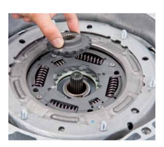
Enlever le circlip de l'arbre creux avec la pince de sécurité (KL-0192-12); la bague s'abîme lors de cette manoeuvre et doit être remplacée.
