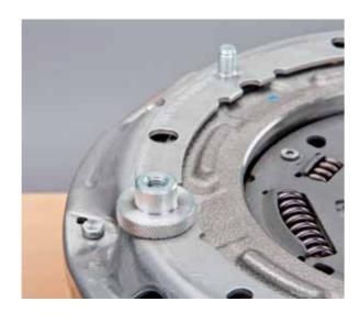
• Ne serrer l'écrou de la broche que jusqu'à ce qu'elle entre en contact avec la pièce de pression.
