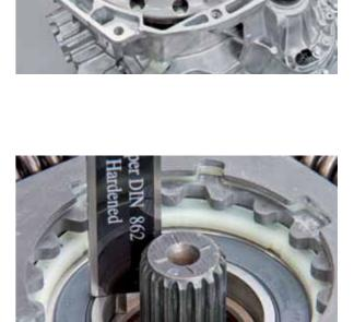
• Poser la douille de pression (KL-0500-8211) sur la bague intérieure du palier de l'embrayage.
