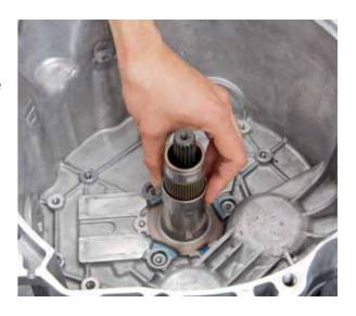
• Serrer les nouvelles vis avec un couple de 8 Nm
