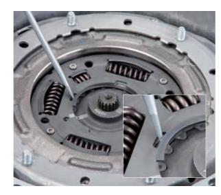
• Enlever le circlip et le moyeu du disque d'embrayage (K1)
