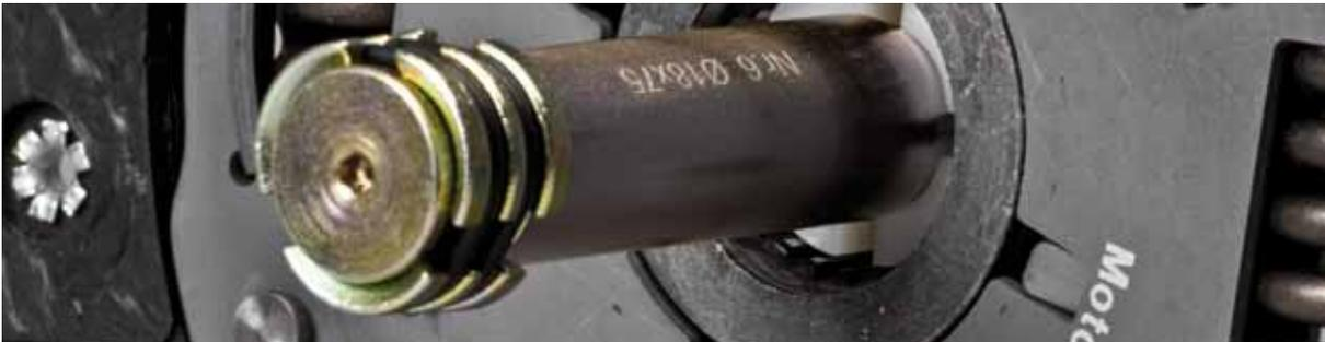
Welche Zusammenstellung des Zentrierdorns zum Einsatz kommt, ist zum einen abhängig vom Innendurchmesser des Führungslagers bzw. der Kurbelwellenbohrung. Zum anderen hängt sie von der Distanz zwischen dem Führungslager bzw. der Kurbelwellenbohrung und dem Nabenprofil der Kupplungsscheibe ab.
