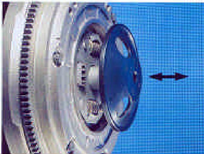
**Instructions d'opération:** En fonction de la disposition spéciale de l'embrayage des véhicules VW susmentionnés, le centrage impeccable du disque d'embrayage n'est possible lors du montage qu'à l'aide de ce dispositif de centrage.
