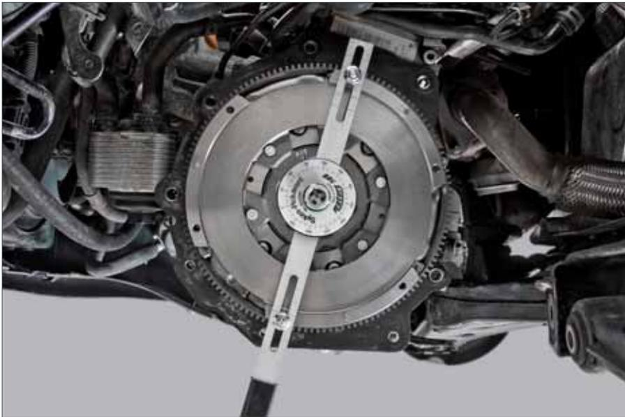
En Volantes Bimasa con un número par de roscas de fijación para el conjunto de presión del embrague, la palanca se puede montar en posición central y determinar así el ángulo libre con el disco graduado. Este tipo de medición es posible con casi todos los volantes motor bimasa y debe utilizarse con prioridad. Ver el capítulo 4.2.
