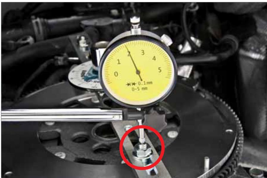
2. Situar el reloj comparador en el centro del adaptador y pretensar de forma correspondiente.
