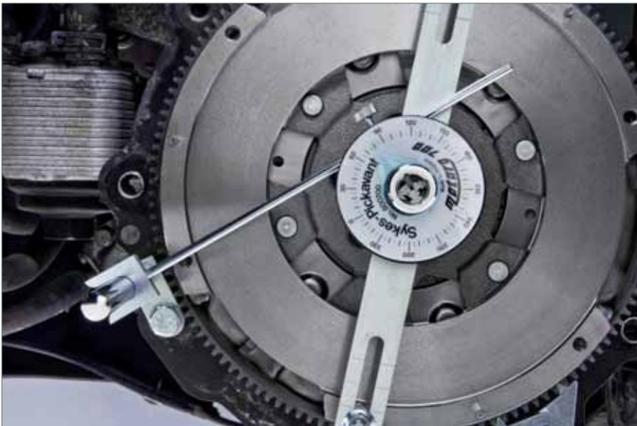
6. Fijar el disco graduado con varilla al soporte del reloj comparador y apretar las tuercas moleteadas .
