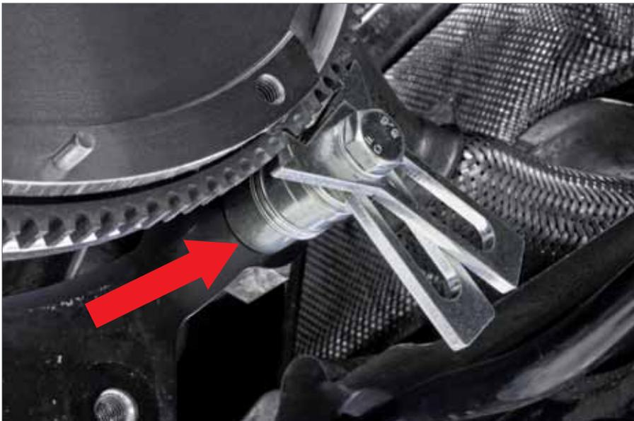
Si la fijación sólo se puede realizar en una rosca con un pasador, éste se puede modificar con el casquillo adjunto.
