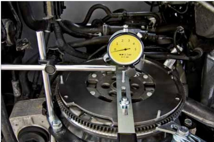
1. Montar el reloj comparador con su soporte en el bloque motor .
