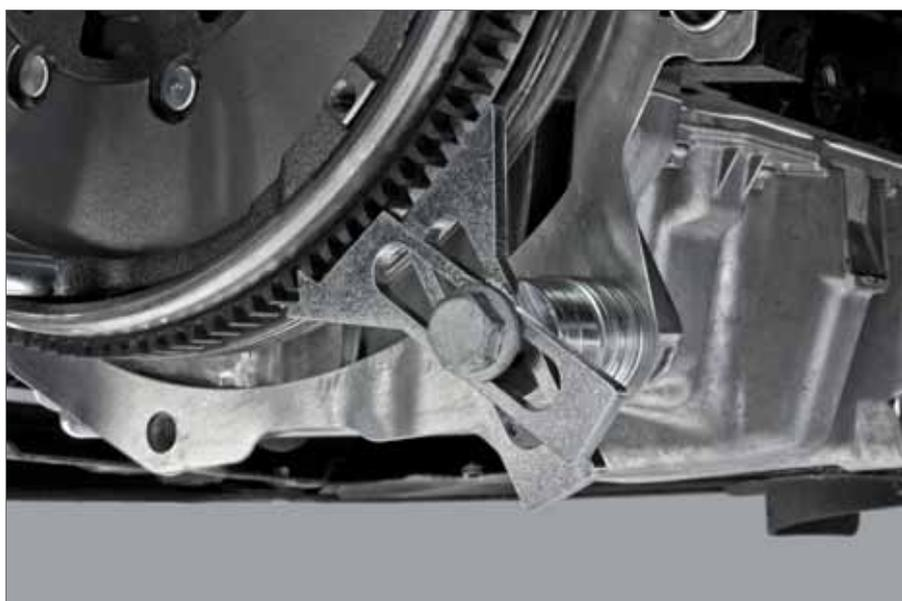
4. Bloquear el Volantes Bimasa: utilizar tornillos de la caja de cambios y, eventualmente, separadores para fijar el bloqueador a la altura del la corona dentada del motor.
