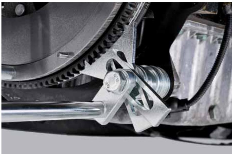
También se pueden montar juntos el bloqueador y el soporte del reloj comparador en un tornillo .
