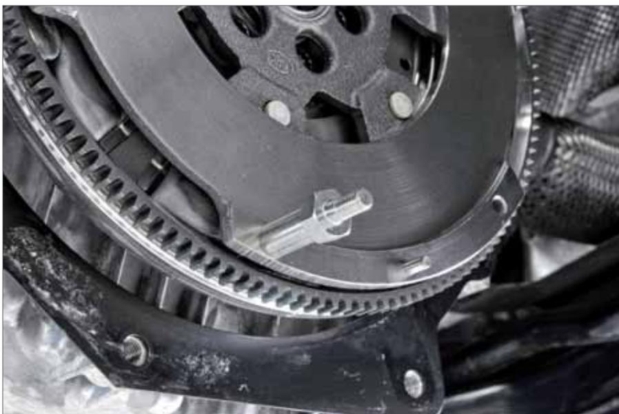
2. Enroscar y apretar firmemente los adaptadores correspondientes (M6, M7 o M8) en los dos orificios roscados verticales opuestos para fijar el embrague en el Volantes Bimasa.
