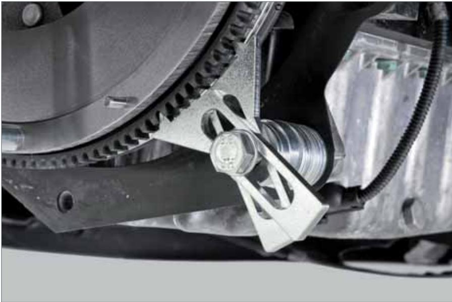
4. Bloquear el Volantes Bimasa: utilizar tornillos de la caja de cambios y, eventualmente, separadores para fijar el bloqueador a la altura de la corona dentada del motor.
