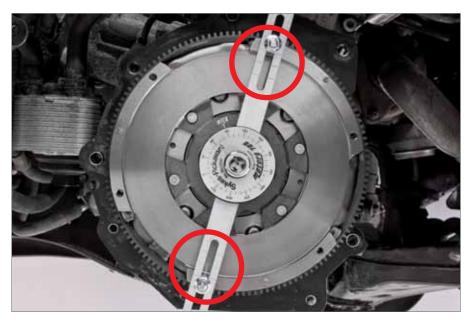
3. Monter le levier sur les adaptateurs – à l'aide des subdivisions, centrer les trous oblongs par rapport aux adaptateurs et serrer les écrous à fond. Le disque gradué en degrés doit se trouver au centre du volant bimasse.
