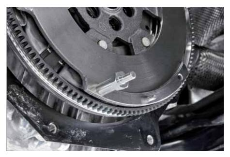
2. Visser et serrer à fond les adaptateurs correspondants (M6, M7 ou M8) dans deux trous de fixation verticalement opposés.
