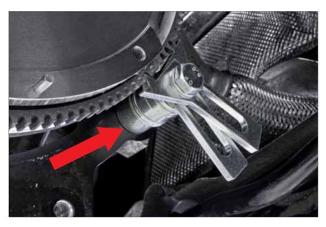
Si la fixation des taquets de blocage n'est possible qu'à partir du téton de centrage de la boite de vitesses, utilisez la douille d'ajustage fournie.
