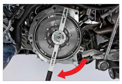
7. Tourner la masse secondaire dans le sens des aiguilles d'une montre jusqu'à perception de la résistance des ressorts en arc. Lâcher progressivement le levier jusqu'à ce que les ressorts en arc soient relâchés.
