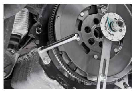
5. Monter le support de comparateur sur le bloc-moteur - utiliser les taquets de blocage et, le cas échéant, la douille, de la même manière que l'outil de blocage.
