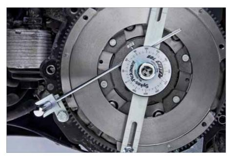
6. Fixer le disque gradué en degrés avec la tringlerie sur le support du comparateur et serrer à fond les écrous moletés.
