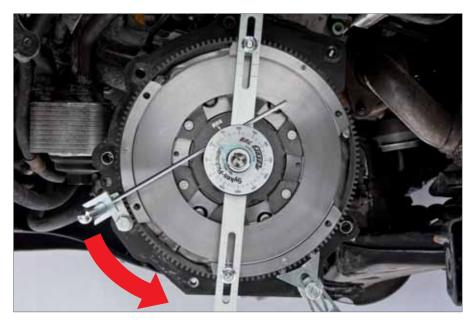
7. Tourner la masse secondaire dans le sens inverse des aiguilles d'une montre à l'aide d'un levier jusqu'à perception de la résistance des ressorts en arc.
