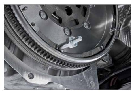
Visser et serrer à fond les adaptateurs correspondants (M6, M7 ou M8) dans deux trous de fixation opposés, approximativement verticaux.
