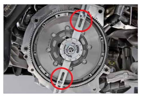
3. Monter le levier sur les adaptateurs –, centrer les trous oblongs par rapport aux adaptateurs et serrer les écrous à fond. Etant en présence d'un nombre impair de trous filetés de fixation pour le mécanisme d'embrayage, le levier ne peut pas être monté au centre du volant bimasse.
