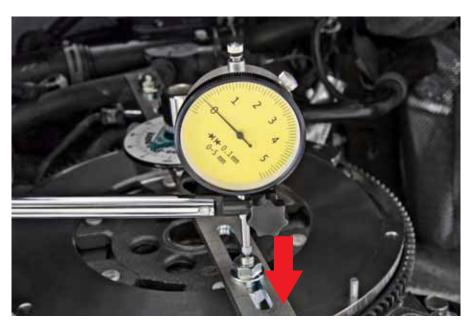
3. Pousser le levier légèrement (avec le pouce par ex.) en direction du moteur jusqu'à perception d'une résistance. Maintenir le levier dans cette position et régler le comparateur sur « o ».
