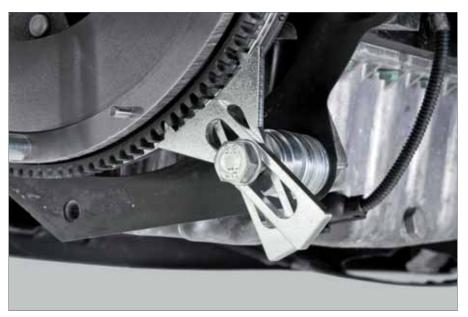
4. Bloquer le volant bimasse – utiliser une vis du tour de boite, et, le cas échéant, des entretoises, pour fixer les taquets de blocage à la hauteur de la couronne de démarreur.
