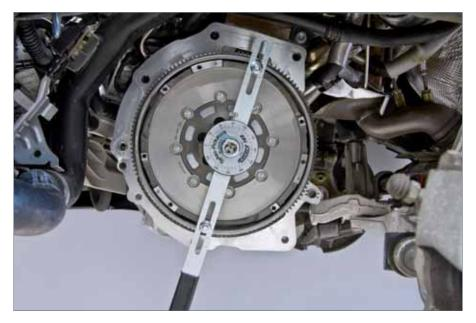
On est plus rarement en présence d'un nombre impair de trous de fixation du plateau de pression d'embrayage, empêchant le montage central du levier. Dans ces cas exceptionnels, l'angle libre doit être mesuré par comptage des dents de la couronne du démarreur - voir Chapitre 4.3.
