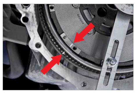
6. Lâcher progressivement le levier jusqu'à ce que les ressorts en arc soient relâchés. Repérer d'un trait les masses secondaire et primaire/la couronne du démarreur à la mê me hauteur.
