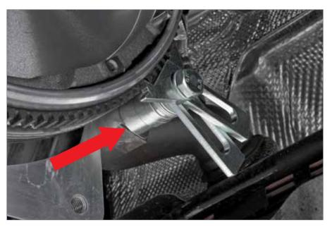
Si la fixation des taquets de blocage n'est possible qu'à partir du téton de centrage de la boite de vitesses utilisez la douille d'ajustage fournie
