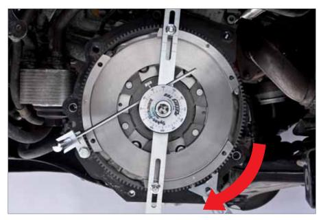
9. A l'aide du levier, faire tourner la masse secondaire dans le sens des aiguilles d'une montre jusqu'à perception de la résistance des ressorts en arc.
