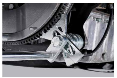
Dans certains cas, il est possible de monter l'outil de blocage et le support du comparateur ensemble sur une vis .
