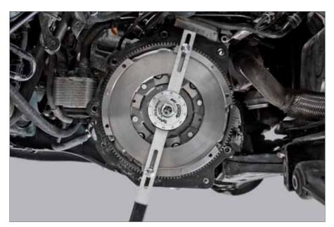
Sur les volants moteurs dotés d'un nombre pair de trous de fixation du plateau de pression d'embrayage, il est possible de monter le levier au centre et, ainsi, de déterminer l'angle libre avec le disque gradué en degrés. Cette méthode de mesure peut être utilisée sur presque tous les volants bimasse et il est conseillé de lui donner la préférence - voir Chapitre 4.2.
