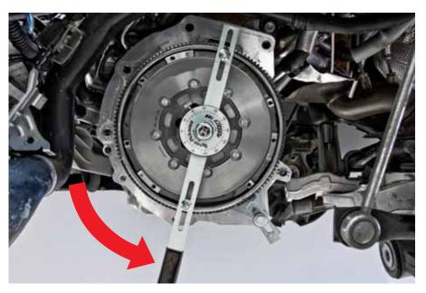
5. Tourner la masse secondaire dans le sens inverse des aiguilles d'une montre à l'aide d'un levier jusqu'à perception de la résistance des ressorts en arc.
