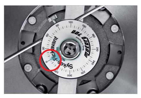
8. Lâcher progressivement le levier jusqu'à ce que les ressorts en arc soient relâchés. Placer l'aiguille du disque gradué en degrés sur « o ».
