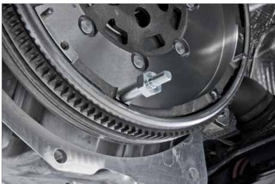
2. Avvitare l'adattatore necessario (M6, M7 o M8) nei due fori filettati contrapposti verticali vicini per il fissaggio della frizione al volano a doppia massa e serrare .
