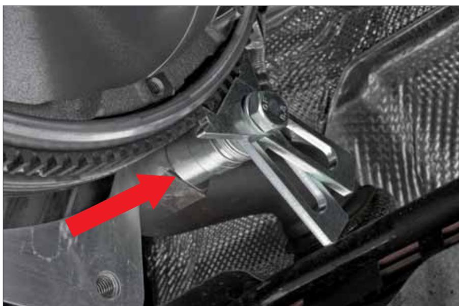
Se i distanziali forniti in dotazione non sono sufficienti, si può raggiungere la distanza necessaria anche inserendo alcune rondelle. Se l'utensile può essere fissato solo a una filettatura con un grado di riferimento, quest'ultimo può essere adattato con la boccola fornita in dotazione.
