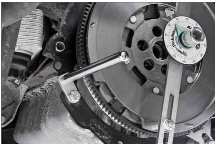
5. Montare il supporto del comparatore sul monoblocco - utilizzare la vite della frizione e all'occorrenza la boccia come l'utensile di bloccaggio.
