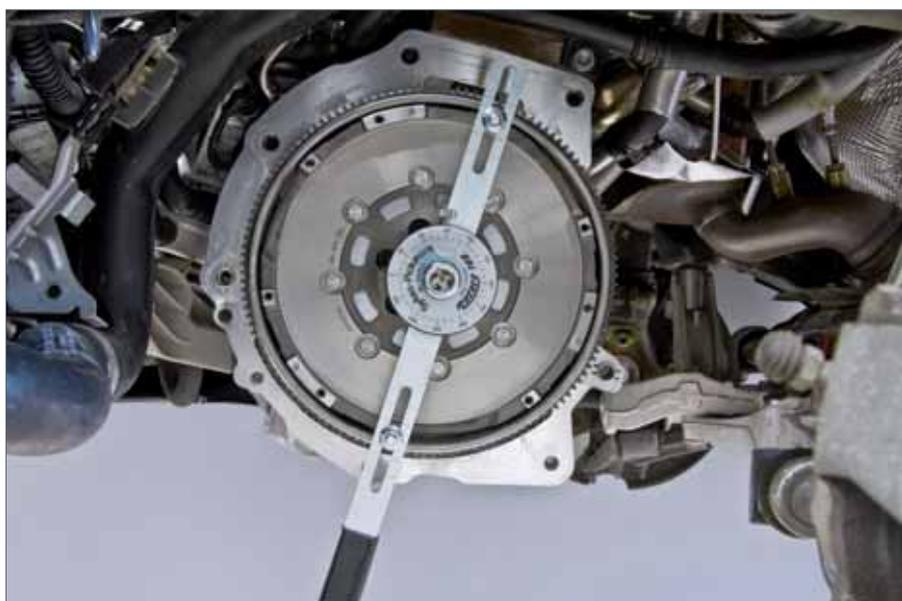
In rari casi è presente un numero dispari di filettature di fissaggio per lo spingidisco della frizione e non è possibile montare la leva al centro (figura 3). In questi casi eccezionali l'angolo di incidenza deve essere determinato contando i denti della corona di avviamento - vedere capitolo 4.3.
