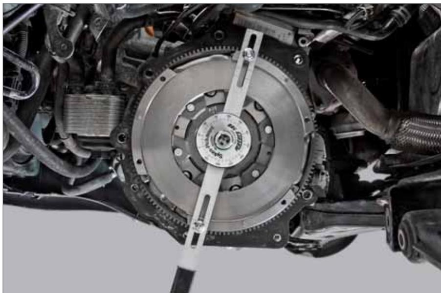
Con i volani a doppia massa con numero pari di filettature di fissaggio per lo spingidisco della frizione, la leva può essere montata al centro (figura 2) e usata per determinare l'angolo di incidenza mediante il disco graduato. Questa procedura di misurazione può essere usata con quasi tutti i volani a doppia massa ed è quella consigliata - vedere capitolo 4.2.
