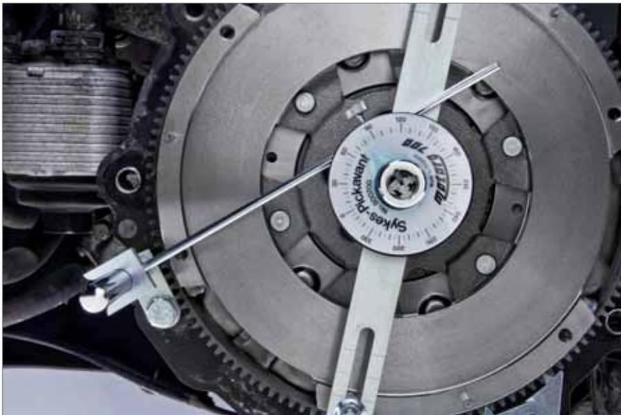
6. Fissare il disco graduato con la tiranteria al supporto del comparatore e serrare i dadi zigrinati.
