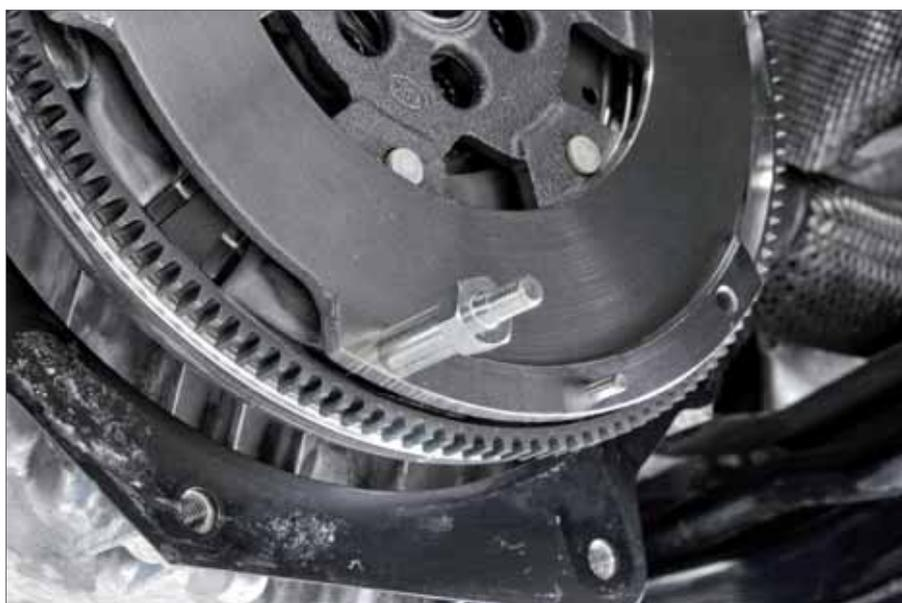
2. Avvitare l'adattatore necessario (M6, M7 o M8) nei due fori filettati contrapposti verticali per il fissaggio della frizione al volano a doppia massa e serrare.
