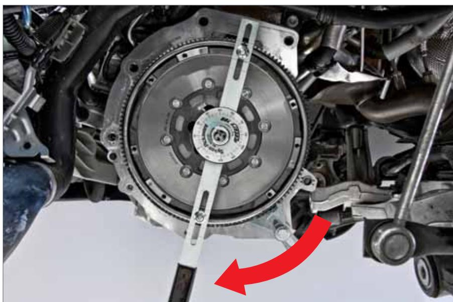
7. Ruotare il disco secondario del volano in senso orario fino a rilevare la resistenza elastica delle molle ad arco. Rilasciare lentamente la leva fino a decomprimere le molle ad arco .
