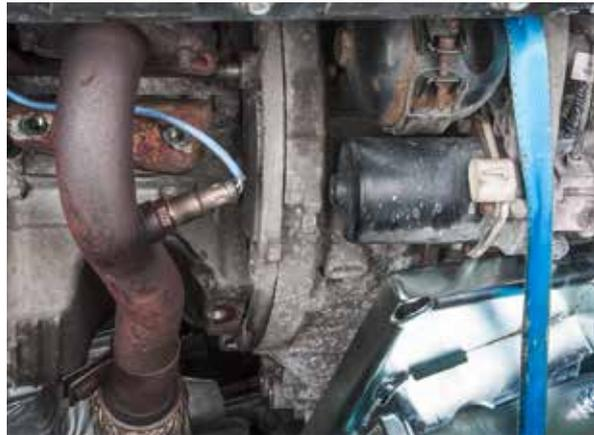
Getriebe so weit wie möglich an den Motor heranführen
