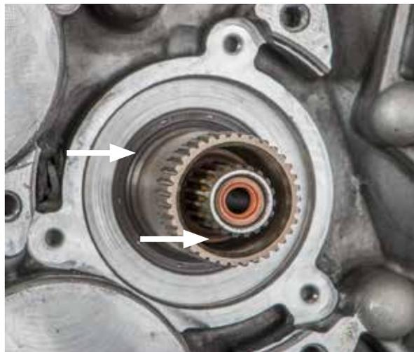
Radialwellendichtring der Betätigungsstange ausbauen
