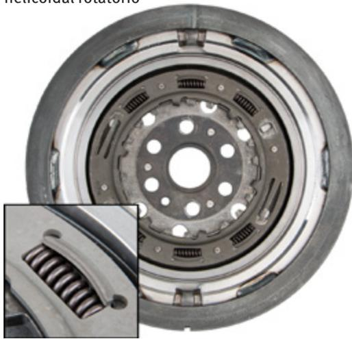
Versión 3: Anillo de tensado sin aleta para un muelle helicoidal rotatorio
