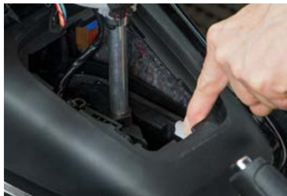
Ο μοχλός αλλαγής ταχυτήτων μπορεί να απασφαλιστεί μέσω ενός κουμπιού πίεσης
