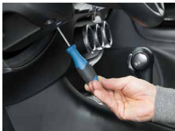
De blokkering van de contactsleutel kan met een schroevendraaier buiten werking worden gesteld.
