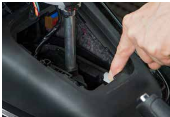
Via een drukknop kan de versnellingshendel worden ontgrendeld
