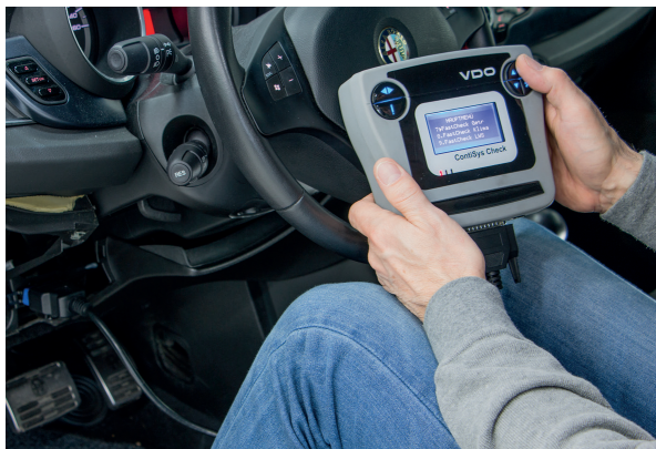
Uygun bir diyagnoz cihazı yardımıyla temel ayarlar yapılmalıdır.
