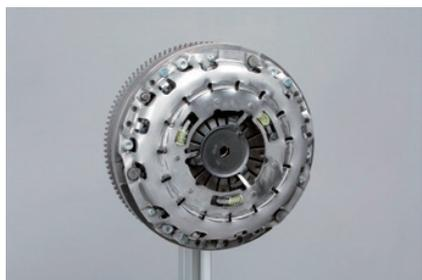
画像 7 : クラッチ圧力板を取り付け、自動車メーカーにより規定されたトルクを使用してねじを順番に均一に締め付けます。
