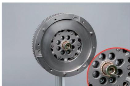
画像 4 : クラッチの組み立て前にセンタリングスリーブを取り付けます (固定ねじを確認してください)。
