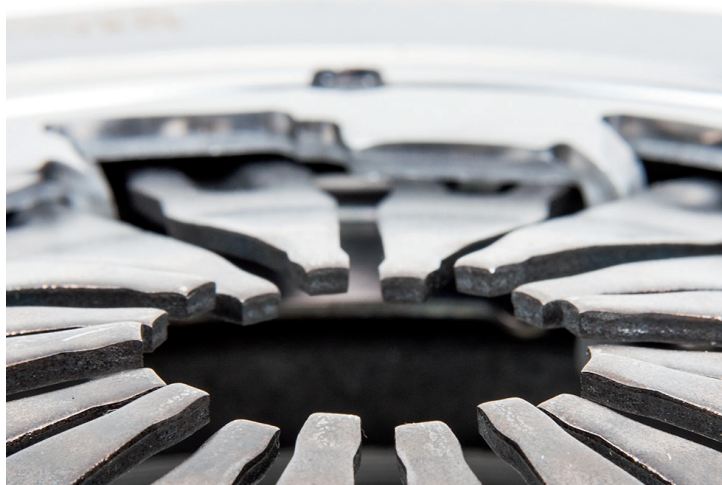
図 1：取り外されたクラッチのダイヤフラムスプリングフィンガーのミスアライメント
