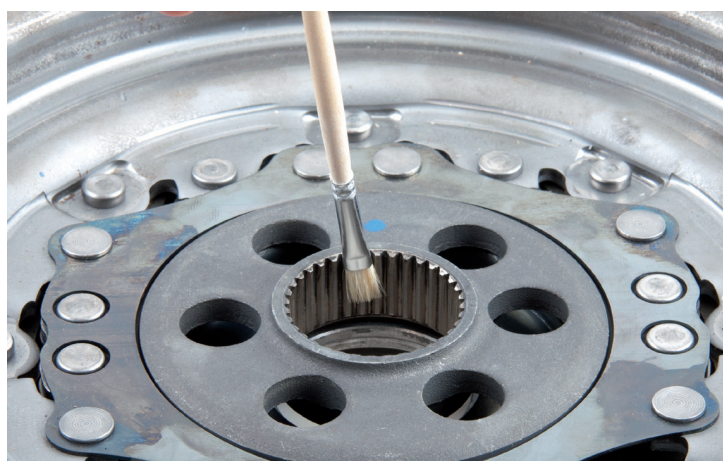
図 1：整備のたびに DMF の内スプラインにグリースを塗布
