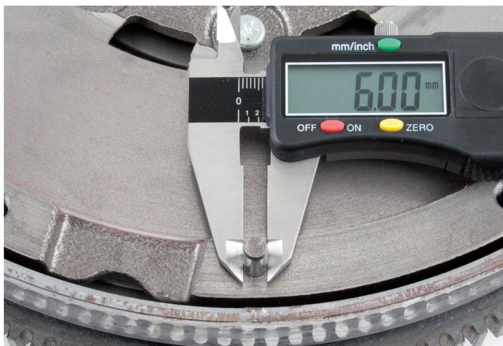
図 1：クラッチのドエルの直径の測定
