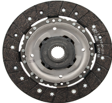
Resim 2: Göbek titreşim sönümleyicili debriyaj balatası (çap 228 mm veya 240 mm)
