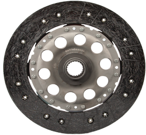
Resim 1: Rijit göbek bağlantılı debriyaj balatası (çap 240 mm)
