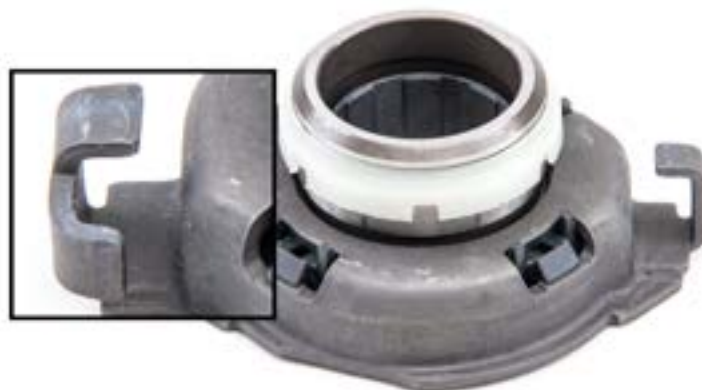
Obrázek 1: U této varianty jsou kontaktní vypínací vidlice součástí skříně
