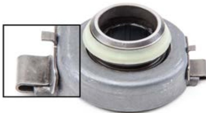
Obrázek 2: Vypínací ložisko s bočními namontovanými plechovými výstupky
