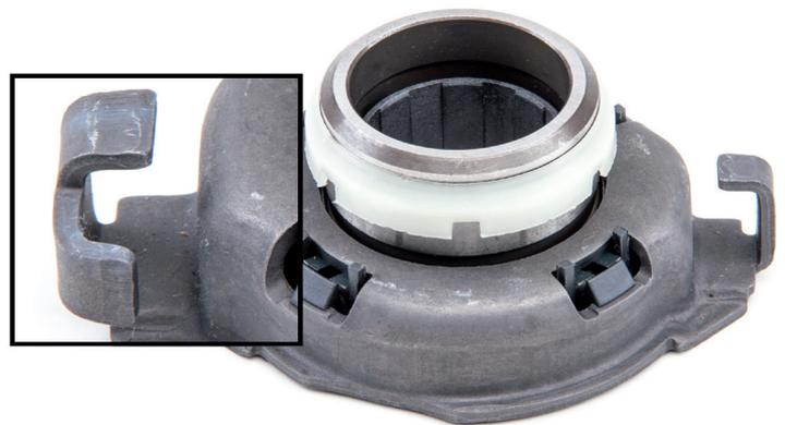
Fig. 1: En esta versión, las superficies de contacto de la horquilla de desembrague forman parte de la carcasa
