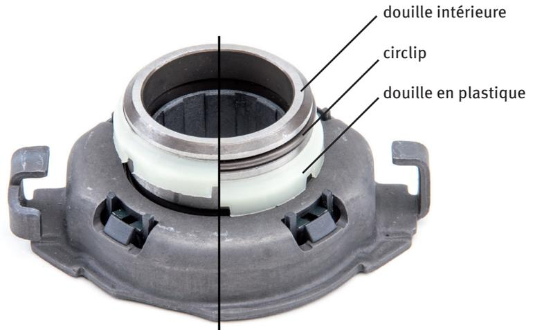
Photo 3: Le circlip est précontraint (à gauche) ou libéré (à droite) par la douille plastique.
