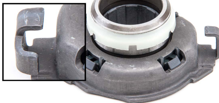
Bild 1: Hos denna variant utgör kontaktytorna med kopplingsgaffeln en del av kåpan
