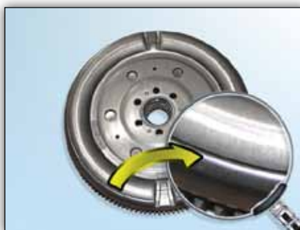
Fig. 6: LuK DMF; partea dinspre motor cu amprentă circulară
