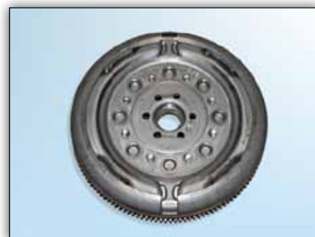
Fig. 7: Sachs DMF; motor fără amprentă circulară
