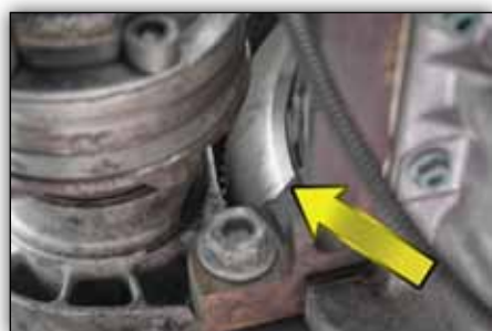
Obrázek 3: Po demontáži krycího plechu je vidět tvar setrvačnicku a je možné rozlišit jeho verzi.
