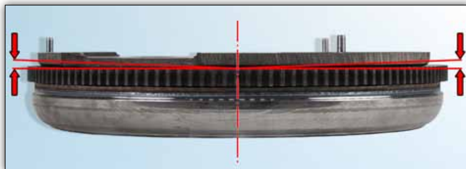
Obrázek 2: Klopná vůle sekundární části setrvačnicku nepředstavuje vadu.
