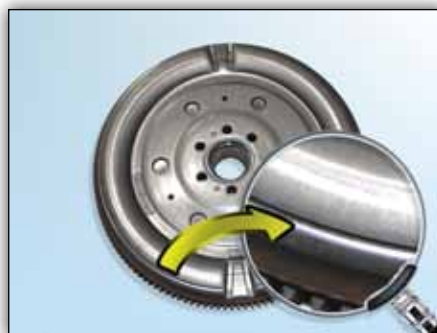
Figur 6: ZMS LuK – side mod motor med en hulning ved periferi
