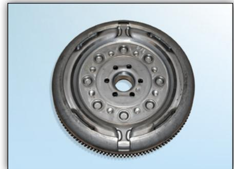
**Bild 7:** Motorseite ohne Vertiefung beim Sachs ZMS
