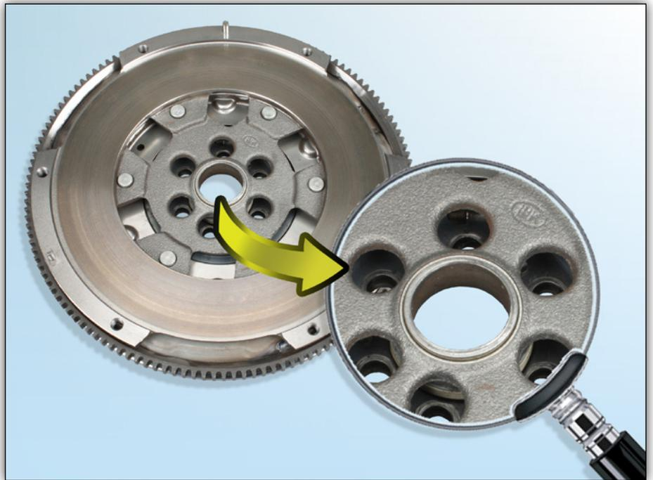
**Bild 1:** LuK ZMS 415 0059 10 mit Gleitlager
