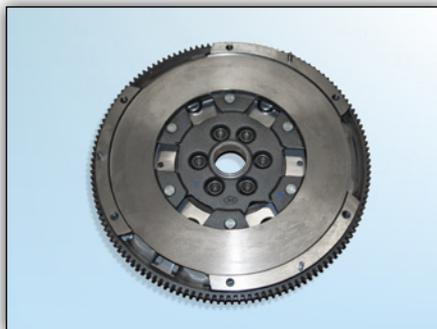
**Fig. 4:** Lado de la caja de cambios del volante bimasa de LuK
