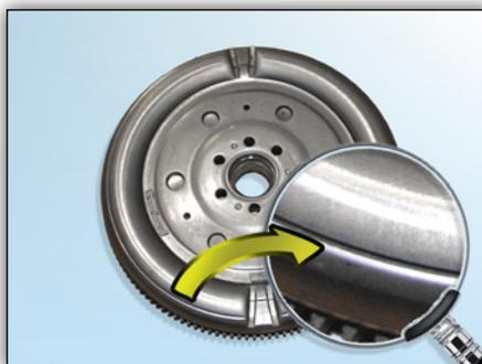
**Fig. 6:** Lado del motor con ahondamiento del contorno con volante bimasa de LuK
