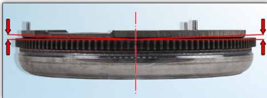
Kuva 2: Vauhtipyörän toisio-osan kallistuman vällys ei ole vika.
