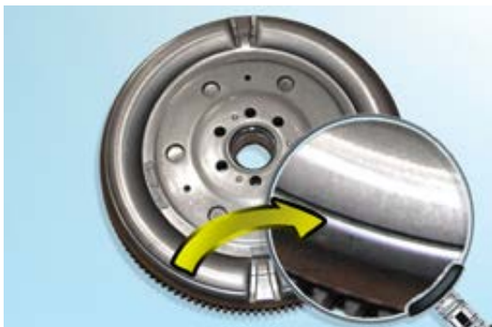
איור 6: גלגל תנופה כפול LuK; צד המנוע עם הזיהוי של הכיסוי ההיקפי
