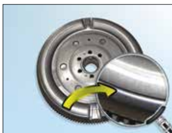
Figur 6: LuK DMF; motorside med innhakk rundt omkretsen
