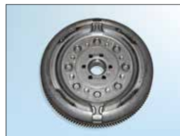
Figur 7: Sachs DMF; motor uten innhakk
