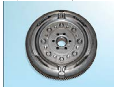
Рис. 7: Sachs DMF, сторона двигателя. Без углублений.
