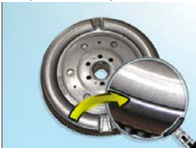
Рис. 6: LuK DMF, сторона двигателя. Углубление на окружности первичной массы.
