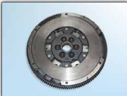
Slika 4: LuK ZMS; Stran menjalnika
