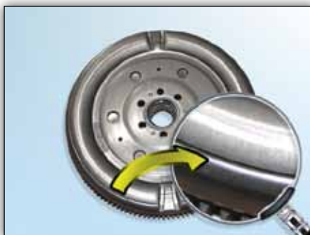
Slika 6: LuK ZMS; motorna stran z zarezo na obodu
