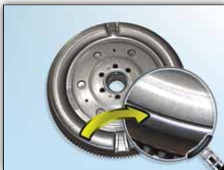
Bild 6: LuK ZMS - sida mot motorn med fördjupning i periferin
