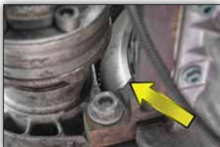
Bild 3: Efter borttagning av täckplåten syns svänghjulets egenskaper och typ kan avgöras.
