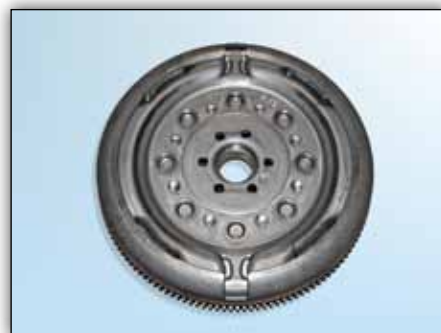
Bild 7: Sachs ZMS - sida mot motorn utan fördjupning
