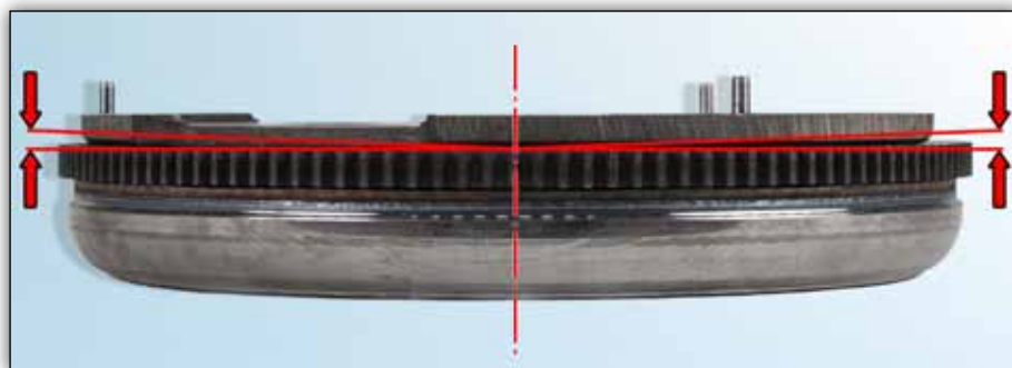
Bild 2: Spelet hos sekundärmassan utgör inget fel.
