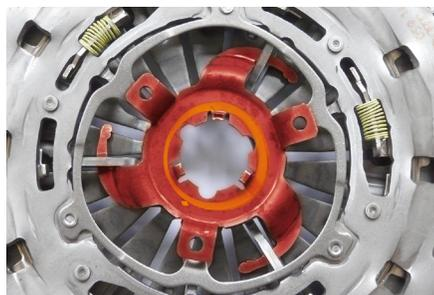
Figura 4: Elemento di bloccaggio
