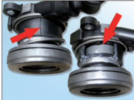
Fig. 5: Rolamento hidráulico danificado por uma instalação incorrecta
