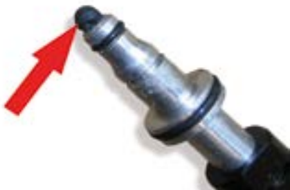
Fig. 4: În cazul în care vechiul închizător nu este îndepărtat, este posibil ca acesta să fie presat în CRC și să blocheze tubul
