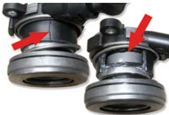
Fig. 5: CRC deteriorat de montarea necorespunzătoare
