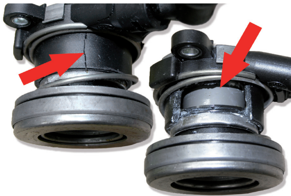
Снимка 5: Повреден от неправилен монтаж хидравличен изключващ лагер (CSC)
