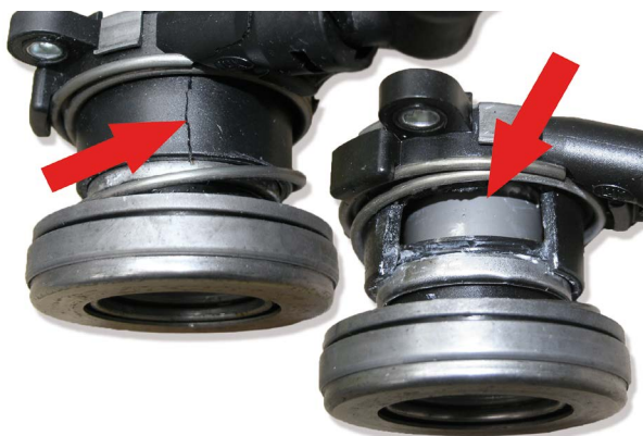
Obrázek 5: Centrální vypínací mechanismus zničený chybnou montáží
