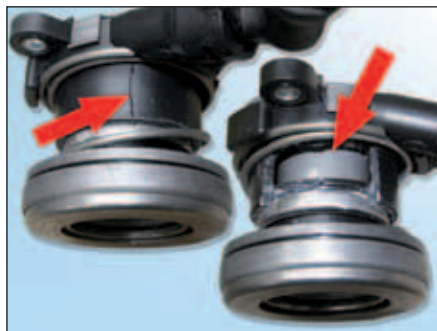
Fig. 5: Central frigørelsesmekanisme ødelagt ved forkert montering
