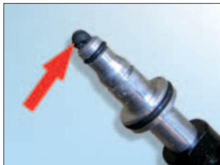
Fig. 4: Hvis den gamle O-ring ikke fjernes, kan den trykkes ind i CSC og blokere det hydrauliske system.
