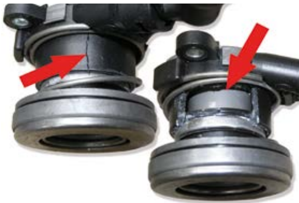
Εικόνα 5: CSC με ζημιές λόγω λανθασμένης τοποθέτησης
