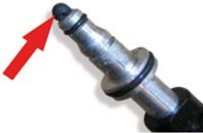
Εικόνα 4: Αν δεν αφαιρεθεί το παλιό o-ring, μπορεί να συμπιεστεί μέσα στο CSC και να μπλοκάρει τον σωλήνα
