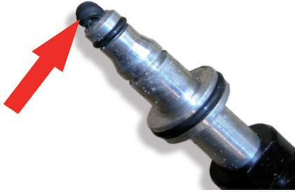
Fig. 4: Si no se ha retirado el anillo de obturación anterior, se presionará hacia el CSC atascando el conducto
