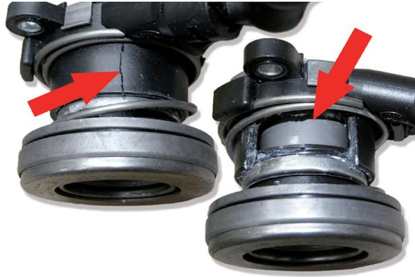
Fig. 5: Cojinete hidráulico dañado por una instalación errónea
